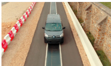
Induktives Laden für den Renault Kangoo Z.E. auf einer Versuchsstrecke. Bild: Renault
